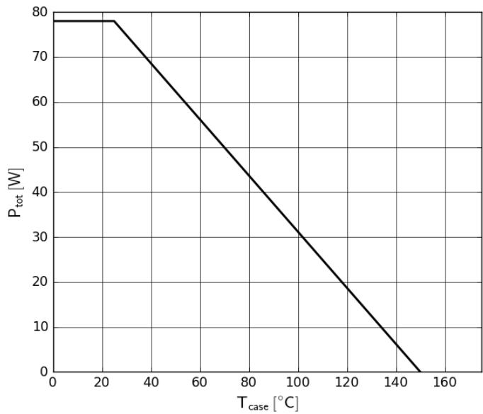
**Figure 14. Power Dissipation**
